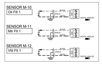
DO NOT CONNECT THE SHIELD DRAIN WIRE TO A MCS CONTROLLER OR SI EXPANSION BOARD ALWAYS CONNECT SHIELD TO EARTH GROUND
